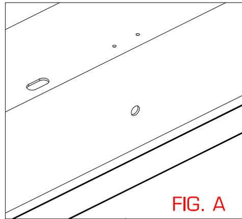
NOTE: MAKE SURE THERE IS A HALF INCH GAP FROM BACK EDGE OF WORKSURFACE TO BACK OF TROUGH (SEE FIG. A).
